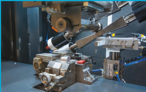
Abb. 12: Arbeitsraum des zur Verfügung stehenden PowerWheel-Ultraschallschweißsystems.
