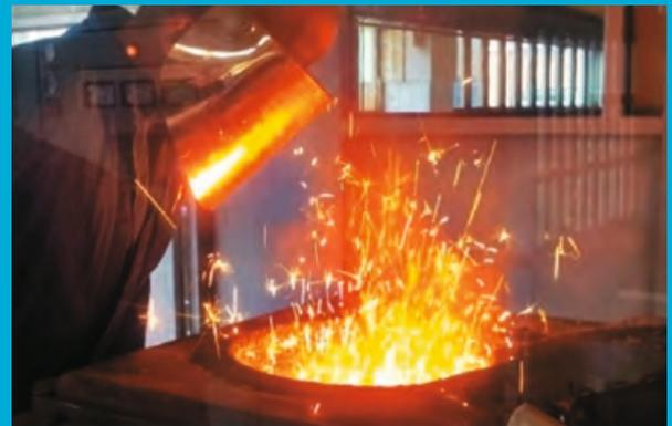
Abb. 13: Erschmelzen einer Eisenbasislegierung im Induktionsschmelzofen.
